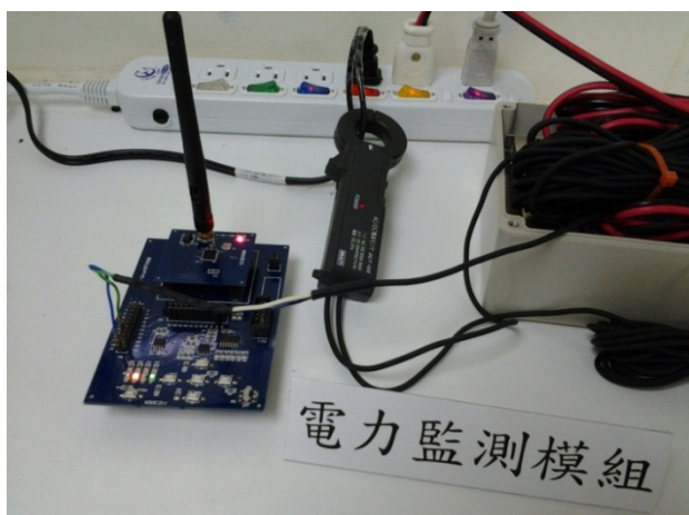
圖 7 PMM 與 ZR 節點實體圖
